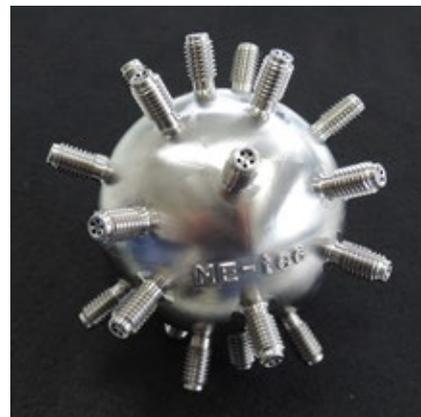
難削鋼材のチタン合金の精密加工見本
