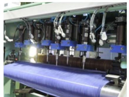
超音波振動によるスリット工程
