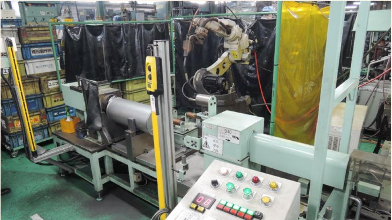
自動溶接機の全体。手前が自動機、中央が溶接ロボット
