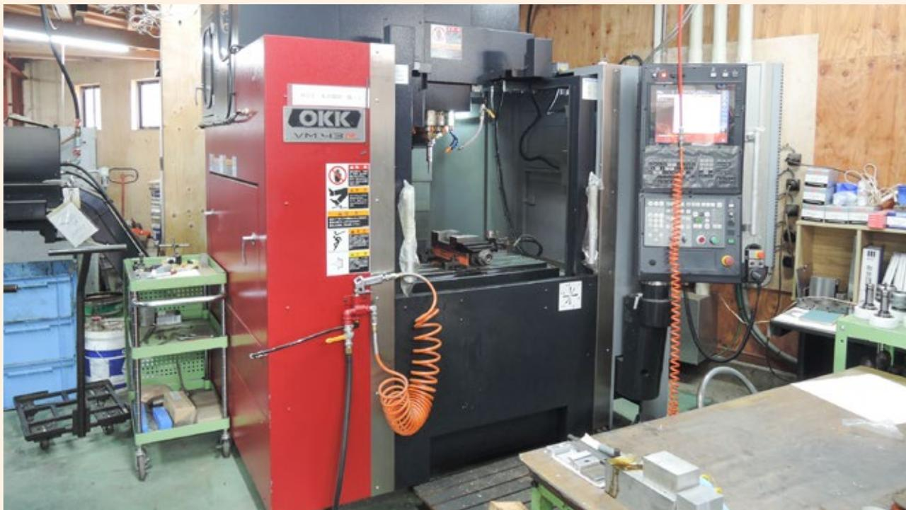
小型部品の小ロット加工に対応するために新たに導入した立形マシニングセンター
