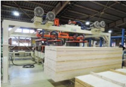
投入ロボット・積載ロボット付き搬送ライン
